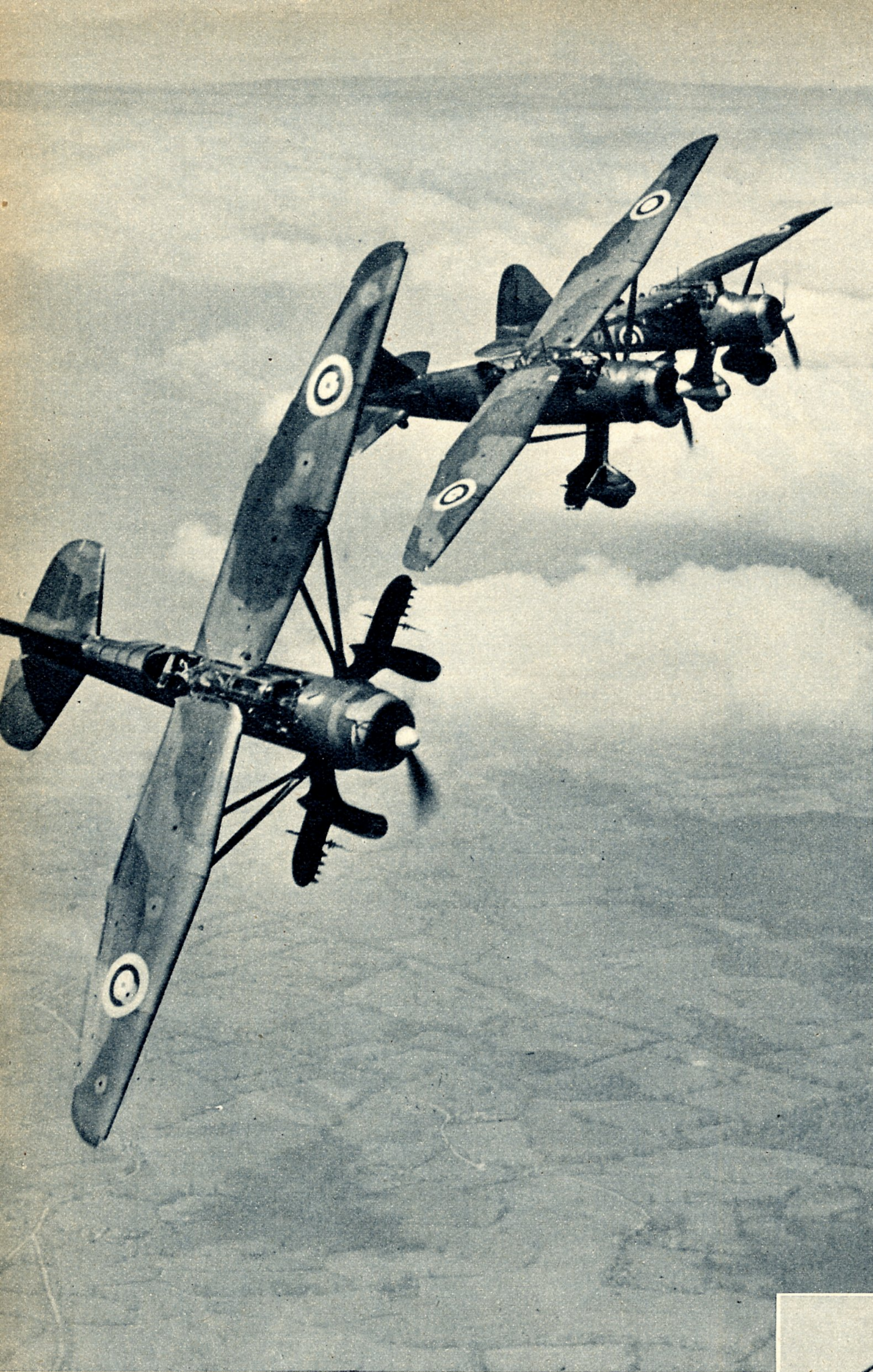
Eine Kette Mehrzwecke-Flugzeuge vom Typ Westland „Lysander“. Das Führerflugzeug kippt ab zum Angriffsfluge. Die Ausleger zu beiden Seiten der Räder dienen zur Aufnahme von Bomben
